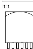
Oberfläche 5-10µm Sn über 2-4µm Cu®
