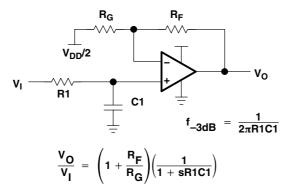
Figure 30. Single-Pole Low-Pass Filter
