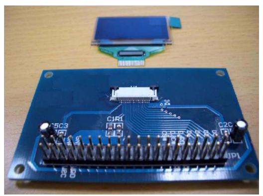
Figure 2 EVK PCB and DD-2832BE-2A Module
