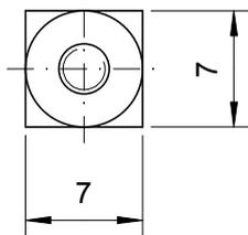
Oberfläche 5-10µm Sn über 2-4µm Cu®
