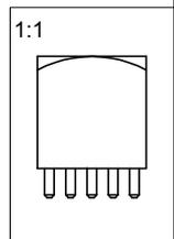
Oberfläche 5-10µm Sn über 2-4µm Cu®
