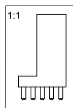
Oberfläche 5-10µm Sn über 2-4µm Cu®
