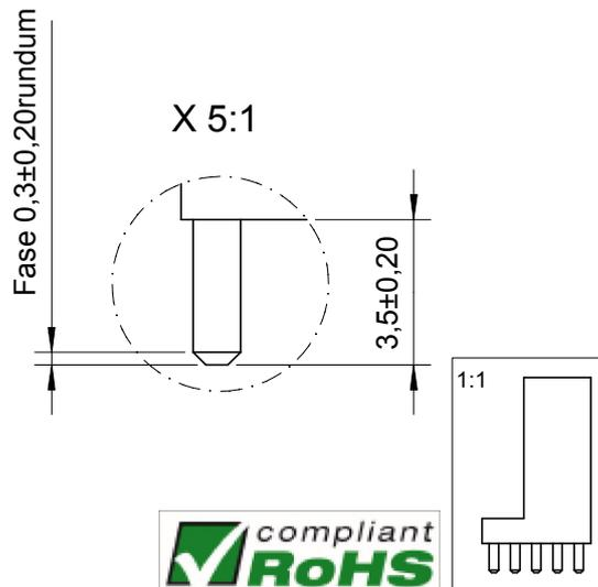
Oberfläche 5-10µm Sn über 2-4µm Cu®
