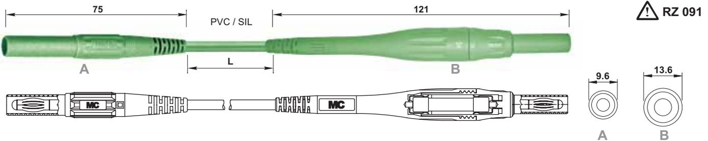
Hoch flexible Sicherungs-Messleitungen mit PVC- oder Silicon-Isolierung, beidseitig mit axialen Ø 4 mm-Lamellensteckern mit starrer Isolierhülse. Der zweiteilige Schraubstecker gestattet die Aufnahme einer Hochleistungssicherung 6,3 x 32 mm. **Lieferung ohne Sicherung.**
