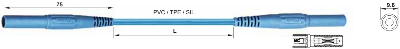
Hoch flexible Messleitungen mit PVC-, TPE oder Silicon-Isolierung, beidseitig mit axialem Ø 4 mm-Lamellenstecker mit starrer Isolierhülse. Durch den sehr hohen Isolationswiderstand der TPE-Isolierung eignet sich die Messleitung XMT-419 hervorragend für hochohmige Widerstandsmessungen.
