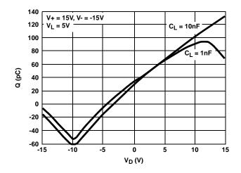
FIGURE 13. CHARGE INJECTION vs DRAIN VOLTAGE
